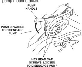
Figure 14. Pump Disengage
